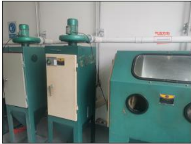
喷砂机、喷珠机自身配备布袋除尘器
